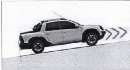
assistente de partida em rampa Mantém a pressão do freio por dois segundos, evitando a reversão quando você se afasta em um declive acentuado.
