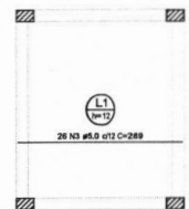
Armação positiva das lajes do pavimento Caixa d'agua (Eixo Y)
